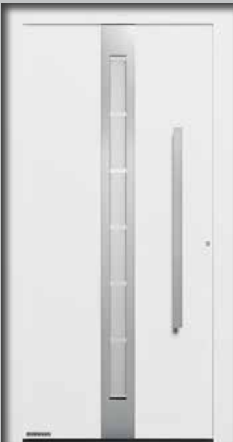
Motiv 686 Edelstahl-Griff HOE 600, Edelstahl-Applikation, Motivglas Float mattiert mit 7 klaren Streifen, 4-fach WSG, zertifizierte Passivhaustür, U_D -Wert bis ca. 0,55 \text{ W}/(\text{m}^2\cdot\text{K})^*
