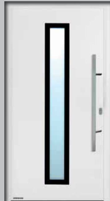
Motiv 600 ■ NEU ab 1.7.2017 Edelstahl-Griff HB 38-2 auf Stahlfüllung, mit aufliegender Verglasung: 3-fach Isolierglas, aussern VSG, in der Mitte Float sandgestrahlt, innen ESG klar, U D -Wert bis ca. 0,98 W/(m 2 ·K)*
