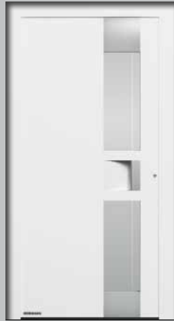
Motiv 302 Flächenbündige Griffleiste serienmässig in Weissaluminium RAL 9006, seidenglänzend, Griffmulde serienmässig in Türfarbe, Edelstahl-Applikationen, Motivglas Float mattiert mit einem klaren Streifen, 4-fach WSG, zertifizierte Passivhaustür, U_D -Wert bis ca. 0,57 \text{ W}/(\text{m}^2\cdot\text{K})^*
