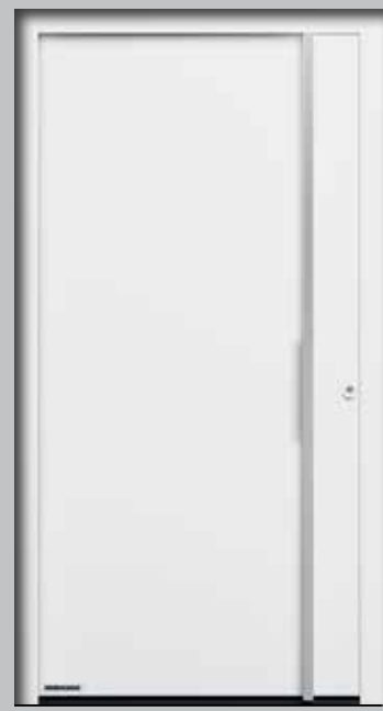
Motiv 823 ■ NEU Griffprofil in Weissaluminium RAL 9006, Befestigungsprofile in Türfarbe, Blendrahmen mit 3D-Effekt und Abschluss durch Griffprofil, optional mit LED-Spotlight im Griff, U_D -Wert bis zu ca. 0,87 \text{ W}/(\text{m}^2\cdot\text{K})^*
