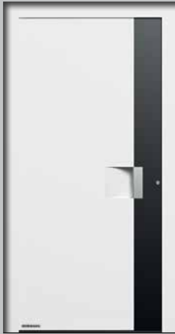
Motiv 301 Griffleiste serienmässig in Weissaluminium RAL 9006, seidenglänzend, Griffmulde serienmässig in Türfarbe, zertifizierte Passivhaustür, U_D -Wert bis ca. 0,50 \text{ W}/(\text{m}^2\cdot\text{K})^*
