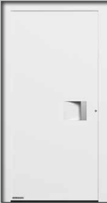
Motiv 300 Griffleiste serienmässig in Weissaluminium RAL 9006, seidenglänzend, Griffmulde serienmässig in Türfarbe, zertifizierte Passivhaustür, U_D -Wert bis ca. 0,50 \text{ W}/(\text{m}^2\cdot\text{K})^*
