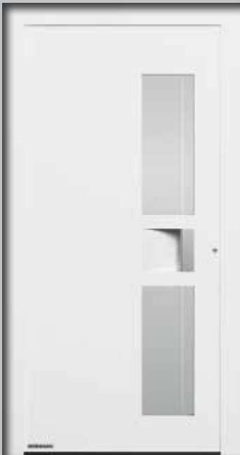
Motiv 312 Flächenbündige Griffleiste serienmässig in Weissaluminium RAL 9006, seidenglänzend, Griffmulde serienmässig in Türfarbe, Motivglas Float mattiert mit einem klaren Streifen, 4-fach WSG, zertifizierte Passivhaustür, U_D -Wert bis ca. 0,57 \text{ W}/(\text{m}^2\cdot\text{K})^*
