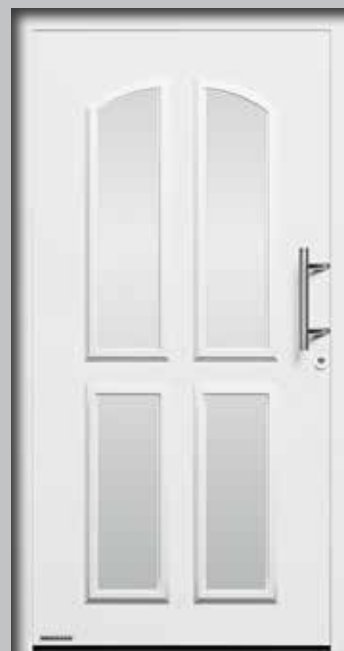
Motiv 402 Edelstahl-Griff 14-2, Motivglas Reflo, teilmattiert mit echtem Rillenschliff, 3-fach WSG, U_D -Wert bis ca. 0,9 \text{ W}/(\text{m}^2\cdot\text{K})^*
