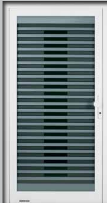
Motiv 100 / MG 113 Standard-Griff Knopf 54, Motivglas aussen VSG mit 25 mattierten Streifen, Mitte Stopsol grau ESG mit 26 mattierten Streifen, innen VSG klar, U_D -Wert bis ca. 1,6 W/(m 2 ·K)*
