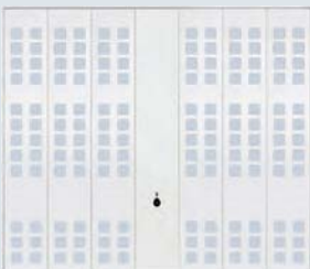
Motiv 988 Stahl-Paneel mit Lüftungsöffnungen (90 x 90 mm) Lüftungsquerschnitt: ca. 25 % der Torfläche
