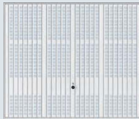
Motiv 914 Stahl-Sicke mit Lüftungsöffnungen (50 x 50 mm) Lüftungsquerschnitt: ca. 30 % der Torfläche
